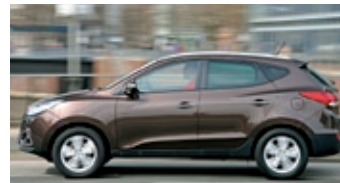
Die extrem hochgezogene Linie der Seitenfenster schränkt die Übersicht nach schräg hinten stark ein
