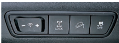
Die elektrische Kupplung des Allradantriebs ist per Lock-Taste beeinflussbar
