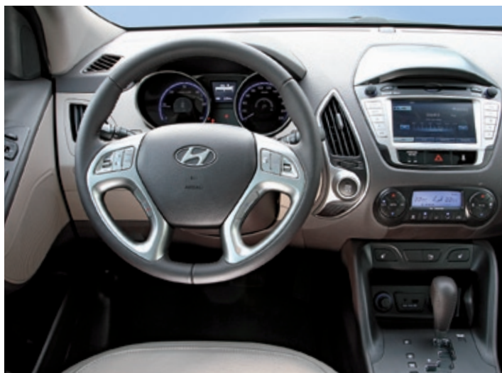
Die Spitzenversion hat selbstleuchtende Instrumente, bei abgeschalteter Zündung ist alles dunkel. Die Sechsstufenautomatik bietet echten Handschaltmodus per zweiter Wählhebelgasse – verzichtet auf Lenkradwippen
